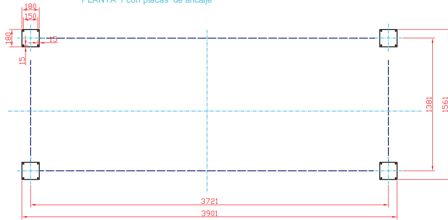
PLANTA / con placas de anclaje
