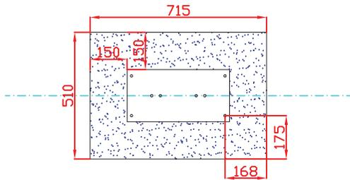
ANCLAJE SOBRE SOLERA DE HORMIGÓN
